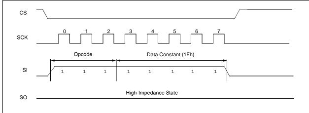
FIGURE 4-7: SYSTEM COMMAND SEQUENCE
